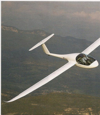
▲ En planeur, la finesse du Taurus tourne effectivement autour des 40 points, un excellent score pour un ULM biplace...
